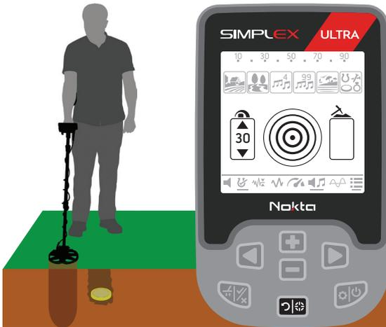
2) Mantenha o botão pressionado e aproxime a bobina sensora do alvo lentamente e paralelamente ao solo.
