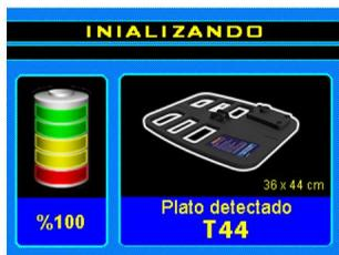
O dispositivo identifica automaticamente a bobina conectada a ele no momento em que é ligado. A bobina anexada será exibida na tela. Se uma bobina diferente da(s) apropriada(s) estiver(ão) conectada(s) ao dispositivo, isso será indicado na tela como um alerta “PLATE ERROR”. Além disso, as informações de status da bateria também são exibidas na tela.
