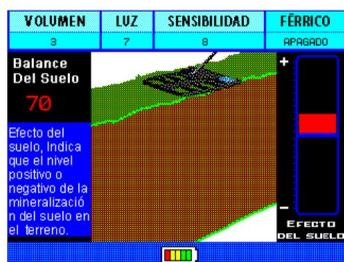
Se o aterramento estiver afetando o dispositivo, será exibido como "GROUND EFFECT" nas barras conforme mostrado na figura. Para remover este efeito, pressione o botão para o botão "0" "-". Repita os passos 8 a 10 até que este efeito seja removido.
