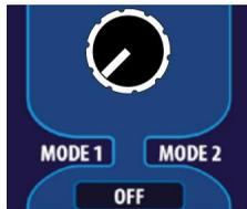
O dispositivo tem dois sistemas separados. Esses sistemas são chamados de Modo 1 e Modo 2. Coloque o botão Liga/Desliga na posição “Modo 1” para operar o dispositivo com o sistema de exibição. O Modo 1 é o modo de operação em que as informações obtidas são apresentadas ao usuário com displays e sons. Este modo é usado para detectar alvos grandes em profundidades significativas.
