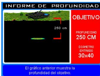
Ao final desses processos, será obtido um relatório de profundidade que mostra os valores de profundidade e as medições inseridas. O valor obtido é aproximado.
