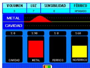
O dispositivo produzirá um sinal sonoro quando detectar um metal ou uma cavidade. Um sinal será produzido a partir dos seguintes objetos: CAVIDADE, METAL, FERROSO E NÃO FERROSO. O efeito no alvo pode ser monitorado consecutivamente no gráfico (osciloscópio) localizado abaixo dessas barras. Neste gráfico, um gráfico ascendente seria obtido para alvos metálicos e um gráfico descendente para alvos como cavidades ou vazios.
