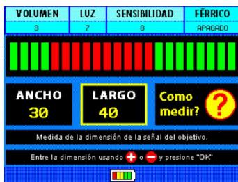
Depois de inserir esses valores, pressione e segure o botão SCAN, depois passe a bobina sobre o alvo, solte o botão SCAN depois que o sinal desaparecer.
