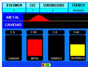
Se o alvo for um metal precioso, uma inclinação é expressa numericamente, dependendo da profundidade do efeito. Isso pode ser mostrado nas barras "METAL" e "NON-FERROUS" (Precious). O efeito metal também pode ser monitorado no gráfico localizado acima das barras.
