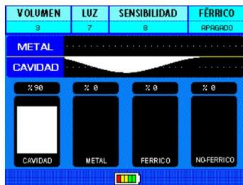
Se o alvo for uma cavidade, uma inclinação será exibida na barra "CAVITY" acompanhada por um gráfico descendente. A força da barra "CAVITY" será exibida numericamente na parte superior, dependendo da profundidade do efeito do alvo.
